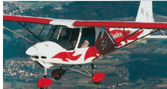
Es gibt zwei Arten von Ultraleichtflugzeugen: Aerodynamisch gesteuerte Ultraleichtflugzeuge, die sich nur durch das Gewicht, bei den modernen Typen jedoch weder durch das Aussehen noch in der Handhabung von Motorflugzeugen unterscheiden, sowie motorisierte Drachen, auch Trikes genannt. Diese Ultraleichtflugzeuge werden durch Gewichtsverlagerung des Piloten gesteuert.
